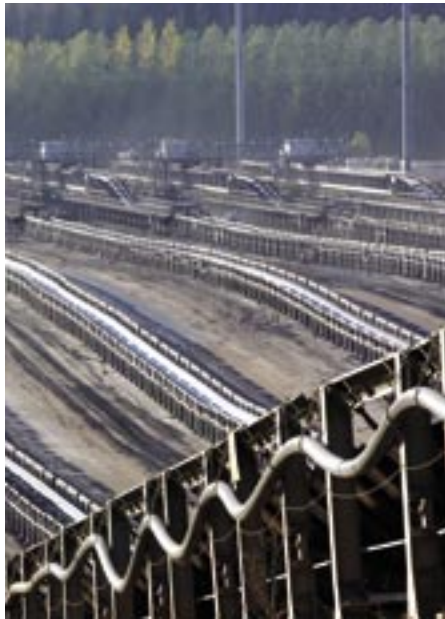
Het zenuwcenter van de Garzweiler open bruinkoolmijn: het materiaal wordt van het Jackerath bandverzamelpunt verdeeld naar de daaropvolgende transportbanden. (Foto: RWE Power)
